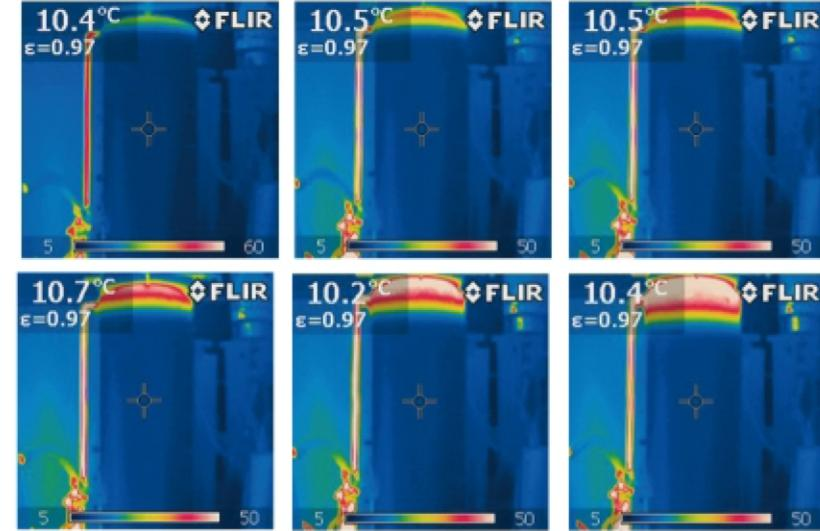
IMMAGINI TERMOGRAFICHE: "caricamento" di Thermocell® in 30 minuti con potenza assorbita dai collettori 3kW
